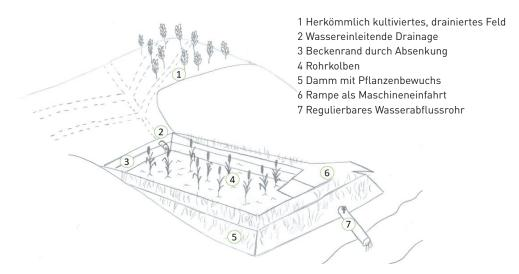
Übersicht eines Rohrkolben-Wasserretentionsbeckens.
